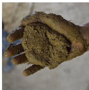
1. Le mélange doit être collant et assez dense pour tenir dans la main.
