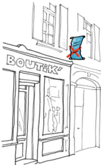
CETTE ENSEIGNE DRAPEAUX N'EST PAS CONSTITUÉE D'UNE MATIÈRE DURABLE ET RISQUE DE SE DÉGRADER RAPIDEMENT ET SON IMPLANTATION DEVANT LA FENÊTRE N'EST PAS CONFORME.
