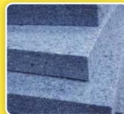
**Métisse® RT** : isolant composé à 85% de coton recyclé, 15 % de liant polyester et 1 % d'un traitement à cœur (ignifuges, antifongiques et antibactériens). Cet isolant d'une densité de 20 Kg/m<sup>3</sup> est proposé en plusieurs épaisseurs. Il est préconisé pour une isolation en intérieur des murs, des cloisons, des rampants de combles aménagés ou des planchers de combles perdus (préférez la formule en rouleaux). Sa légèreté et sa texture assurent une rapidité et un confort de pose.
