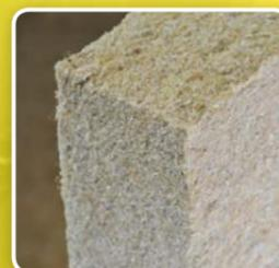
**Biofib'ouate** : panneaux composés de ouate de cellulose (papier recyclé en France) et de fibres de chanvre. Cette combinaison de deux matériaux apporte une très bonne isolation phonique. Avec une densité de 45 kg/m<sup>3</sup> et une épaisseur comprise entre 4,5 et 10 cm, ce matériau est parfaitement adapté pour l'isolation de cloisons séparatives ou de planchers.
