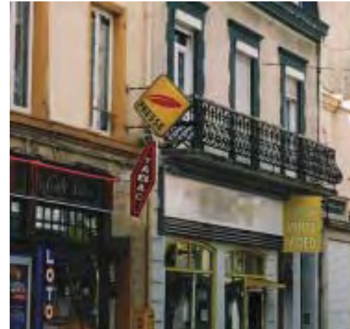
Application de la charte signalétique : enseignes perpendiculaires limitées en surface à 0,7m 2 maximum et en nombre à 2 dispositifs par commerce..
