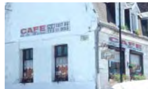
Application de la charte signalétique : caissons lumineux interdits, enseignes alignées avec les ouvertures, pas plus de 2 enseignes parallèles au mur par façade.
