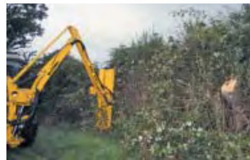
Une fois sélectionnées, les haies ont été taillées à 2,20m à l'aide d'un lamier à scies circulaires. Les arbres de haut-jet sont éliminés et les têtards destinés à être transplantés sont étêtés.
