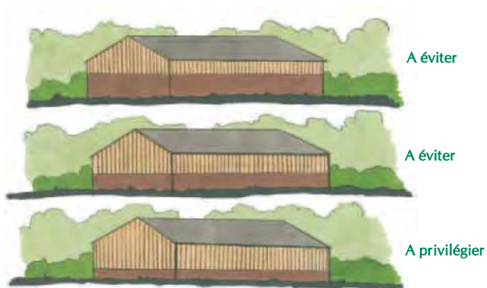
Incidence de la hauteur du soubassement sur l'effet de masse du bâtiment
